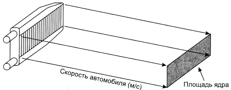
Рис. 5-14. Оценка количества охлаждающего воздуха, проходящего через промежуточный охладитель
