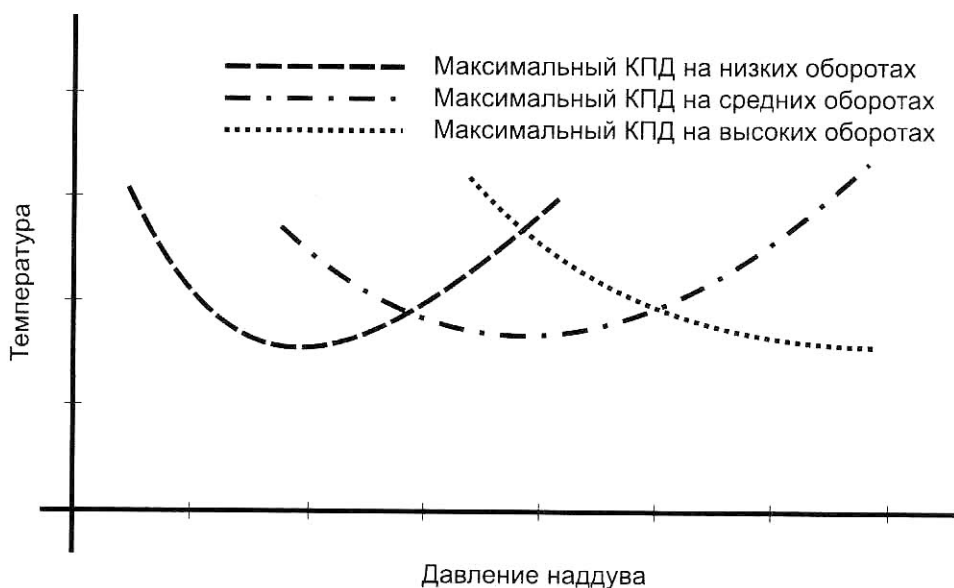
Рис. 3-2. С небольшим турбонагнетателем точка максимальной эффективности достигается рано, и минимум тепловыделения будет на низких давлениях наддува. Чтобы снизить температуру при достижении большой мощности, необходим большой турбонагнетатель.
